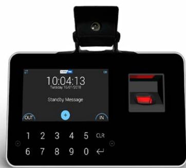
Ejemplo de MITO-03 instalado en el terminal X3 BIO
