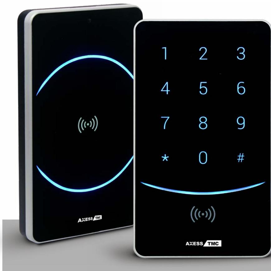
*XA4 e XA4K sono i terminali AxessTMC innovativi e versatili, progettati per l'identificazione automatica. Altamente affidabili e di dimensioni compatte, i terminali sono disponibili anche con tastiera (XA4K) per garantire un doppio sistema di riconoscimento PIN + badge.*
