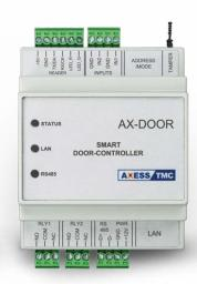
Contrôleurs de passage polyvalents et totalement commandés par une interface web intuitive à partir de n'importe quel navigateur.
